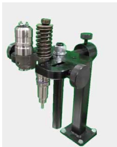
Установка в струбцине насос-форсунки SCANIA Ч-образной
