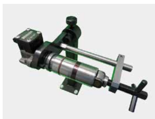
Установка в струбцине насосной секции MB ACTROS
