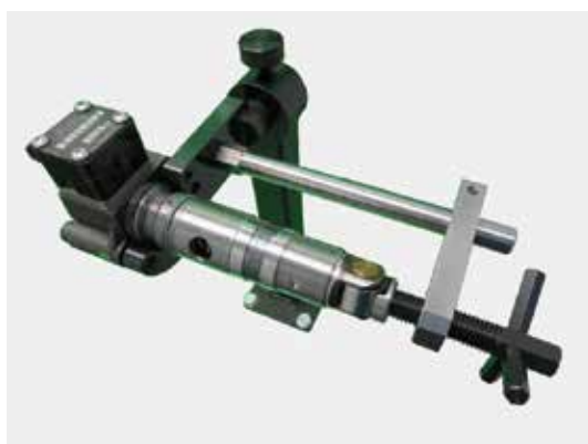
Установка в струбцине насосной секции MB ATEGO
