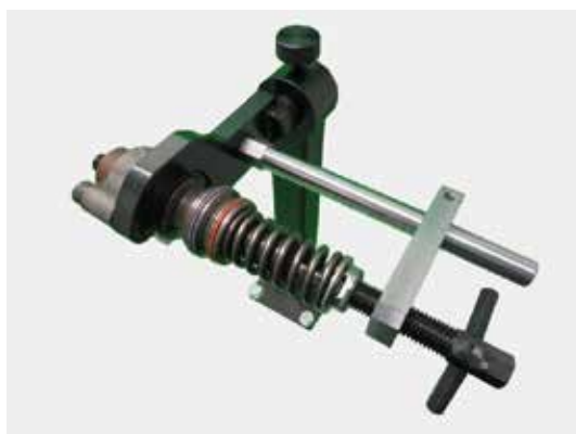
Установка в струбцине насосной секции Delphi 082240354
