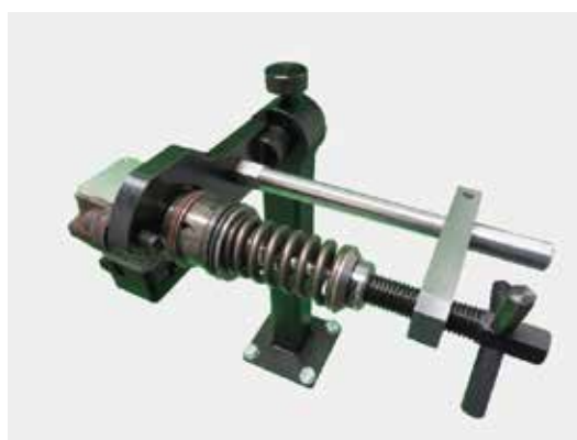
Установка в струбцине насосной секции DAF Bosch 0414755005
