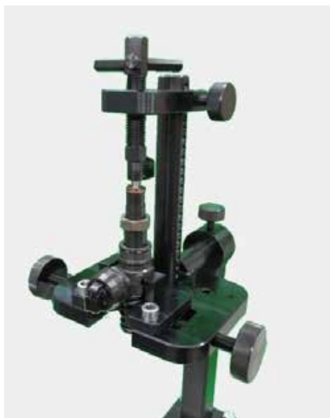
Установка в струбине насос-форсунки AUDI / VW 1.9
