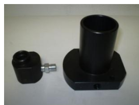
CB 0129-01 ACT Зажим для форсунок Mercedes Actros Комплект поставки: зажим 1 шт, адаптер AZ0309-01 1шт, боковой штуцер DL-EA 1шт
