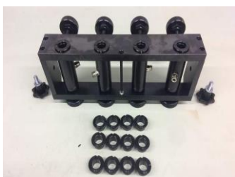
DL-CR10015 DL-RFJ Рамка - держатель форсунок со стаканами- зажимами для распылителей на 7 мм
