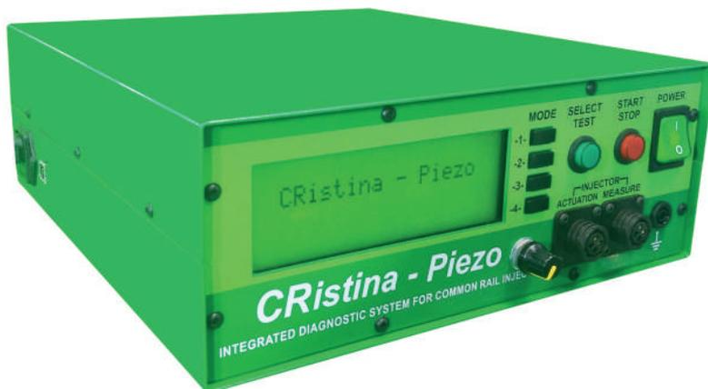
Прибор **CRistina-PIEZO** разрабатывался для сборки форсунок Siemens, но работоспособен и с форсунками Bosh.
