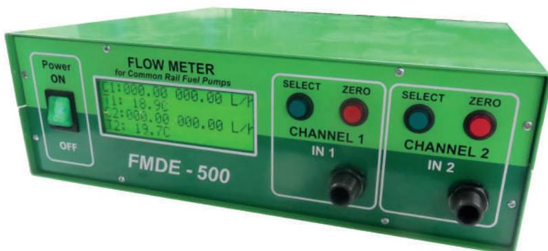
Прибор «**FMDE-500**» предназначен для тестирования и проверки производительности дизельных топливных насосов высокого давления (ТНВД) системы Common Rail.
