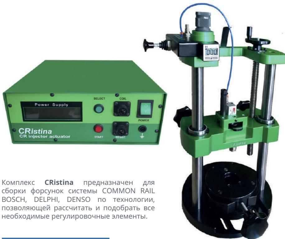
Комплекс **CRistina** предназначен для сборки форсунок системы COMMON RAIL BOSCH, DELPHI, DENSO по технологии, позволяющей рассчитать и подобрать все необходимые регулировочные элементы.
