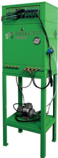
Комплекс **FLAGMAN Code** предназначен для диагностирования форсунок системы CommonRail производства фирм Bosch, Denso, Delphi, Siemens VDO на стенде. Проверка форсунок обеспечивается за счет подачи управляющего сигнала от контроллера на испытываемые форсунки и поддержания требуемого давления в системе согласно выбранному тест-плану.
