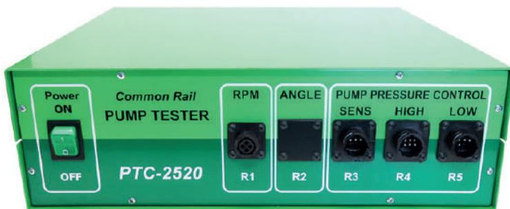
Контроллер «PTC-2520» предназначен для подачи программируемых пользователем сигналов управления регуляторами давления испытательной системы и ТНВД системы Common Rail для проверки их работоспособности.
