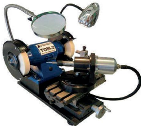
Станки модели **TOM2 CP-230** предназначены для заточки тел вращений (сверл, фрез, кернов, притиров и др.) с углом в диапазоне от 82 до 124 градусов с зажимом их в цанговом патроне. Также устройство предназначено для заточки сверл, фрез, кернов, стамесок, ножей, долот и другого режущего и слесарного инструмента ручным способом. В качестве рабочего инструмента в заточном станке используются шлифовальные (заточные) круги.
