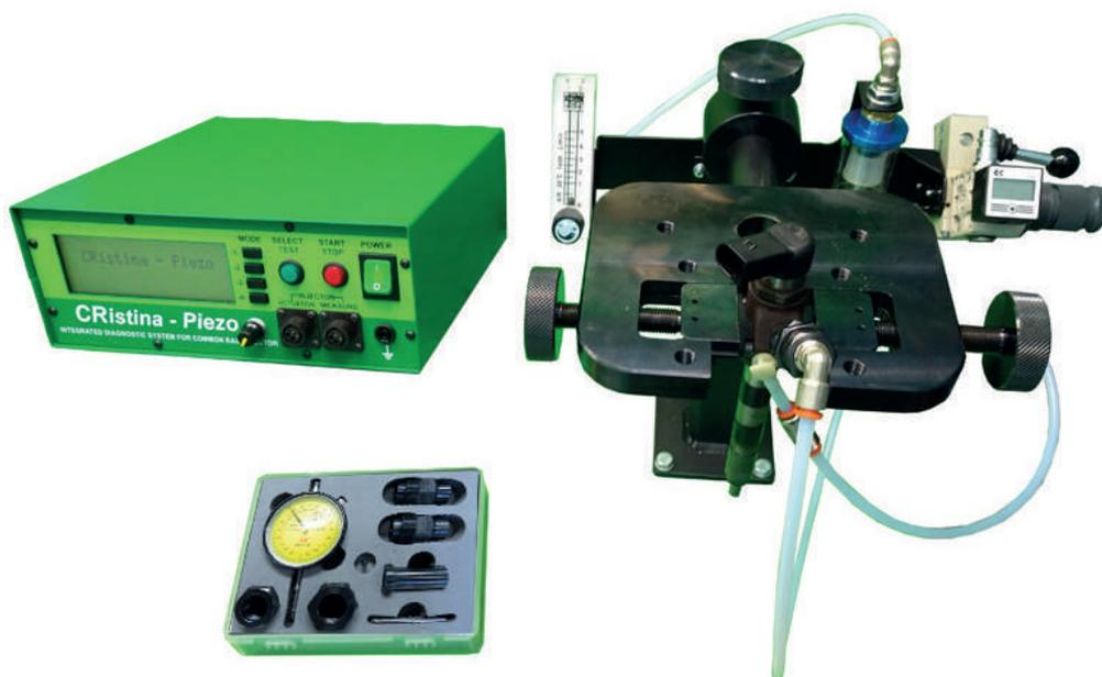
Генератор сигналов «**CRistina-PIEZO**» предназначен для подачи сигнала управления на пьезопакет форсунок COMMON RAIL, для измерения и анализа электрических и механических параметров форсунки при ее проверке или ремонте.
