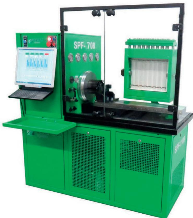
Стенд **SPF-708** предназначен для испытаний и регулировки устройств системы питания дизельных двигателей при проведении их ремонтов и техническом обслуживании.
