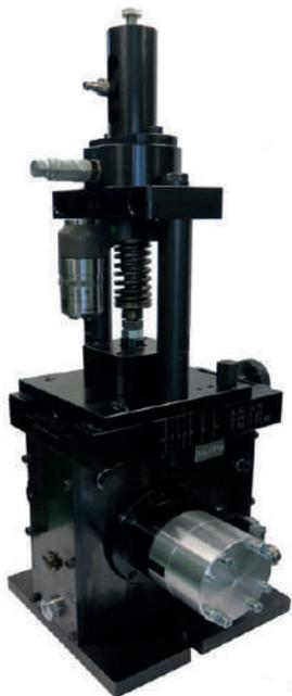
**CAM-BOX2 MECHANIC** устанавливается на стенде стандарта 125мм. Для стендов других стандартов применяется переходная плита не входящая в комплект поставки.
