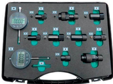
Набор адаптеров с дигитальными индикаторами для измерения монтажных зазоров и хода иглы распылителя и клапана форсунок CR
